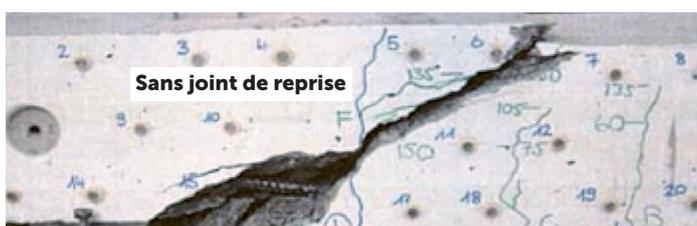
Réponse à la rupture en cas de sollicitation par cisaillement ou moment, sans joint de reprise.
