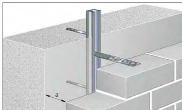
Liaison entre parois en maçonnerie et éléments en béton armé grâce à des rails et ancres de raccordement
